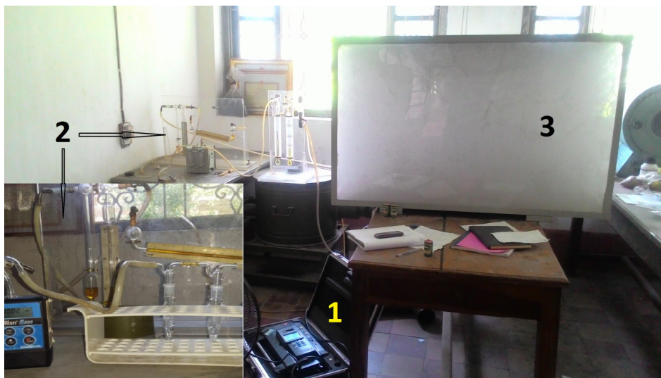
Hình 1. Hệ thống buồng phát khói và lấy mẫu kiểm tra các chỉ tiêu khói. (1- thiết bị kiểm tra; 2- hệ thống lấy mẫu, kiểm tra lưu lượng; 3- buồng phát khói).
