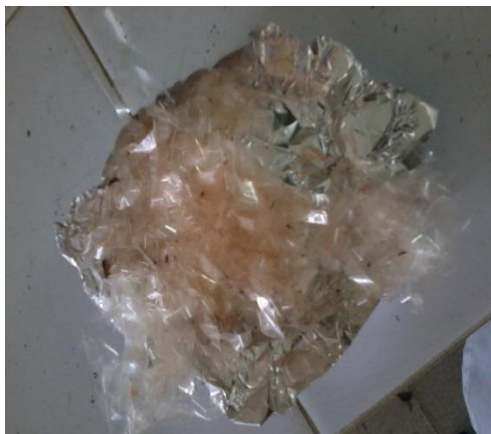
Hình 5. Dây băng đun với acetone trong 4 giờ
