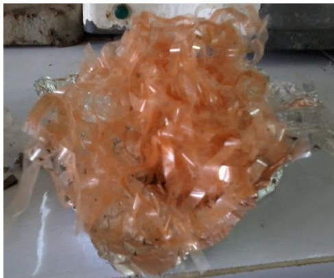
Hình 6. Dây băng đun với acetone trong 6 giờ
