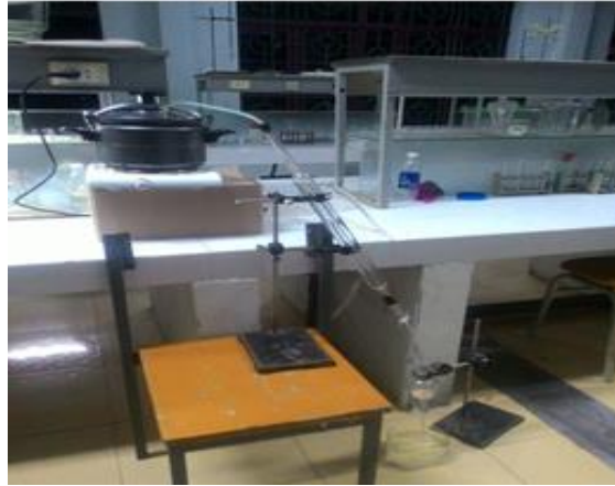
Hình 3. Hệ thống chưng cất lôi cuốn hơi nước cây giổi xanh trong phòng thí nghiệm
