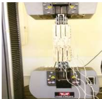
Hình 2. Thí nghiệm kéo các tùy biến liên kết «thép - gỗ»
