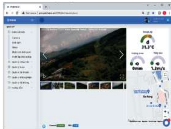
Hình 7. Giao diện Web hiển thị dữ liệu hình ảnh Camera, tốc độ gió, nhiệt độ và lượng mưa
