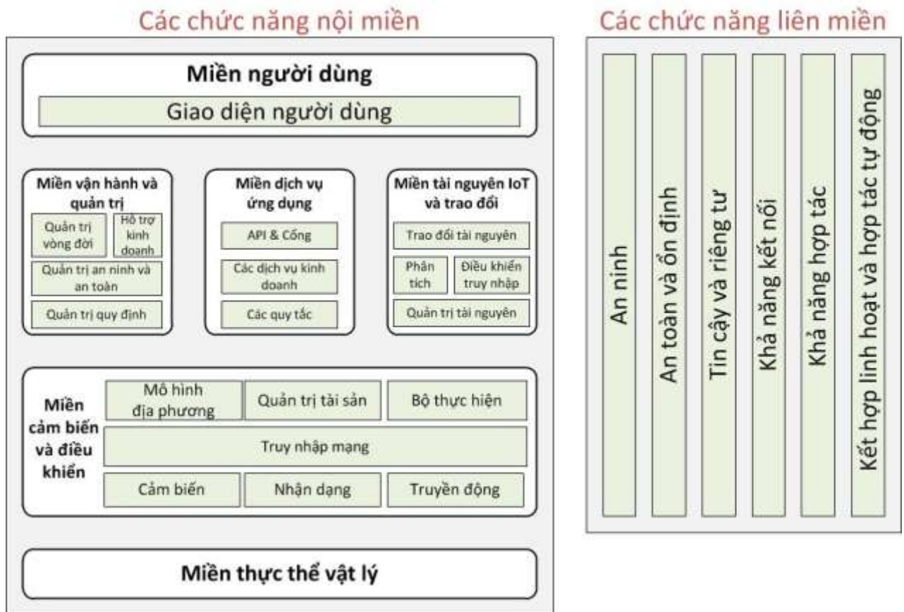
Hình 8 - Góc nhìn chức năng của Khung tham chiếu IoT – phân chia các thành phần chức năng của Khung tham chiếu IoT
