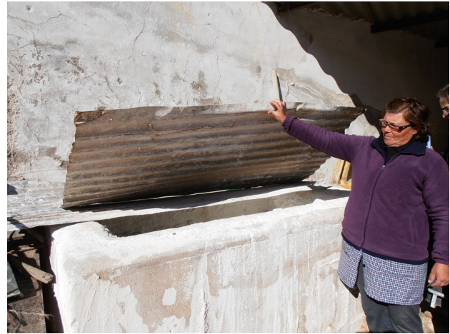
Figura 5. Armazenamento da cal em pasta.
