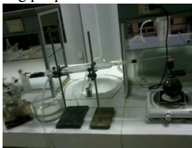
Hình 2. Hệ thống chưng cất lôi cuốn hơi nước tinh dầu lá cây đinh lăng.
